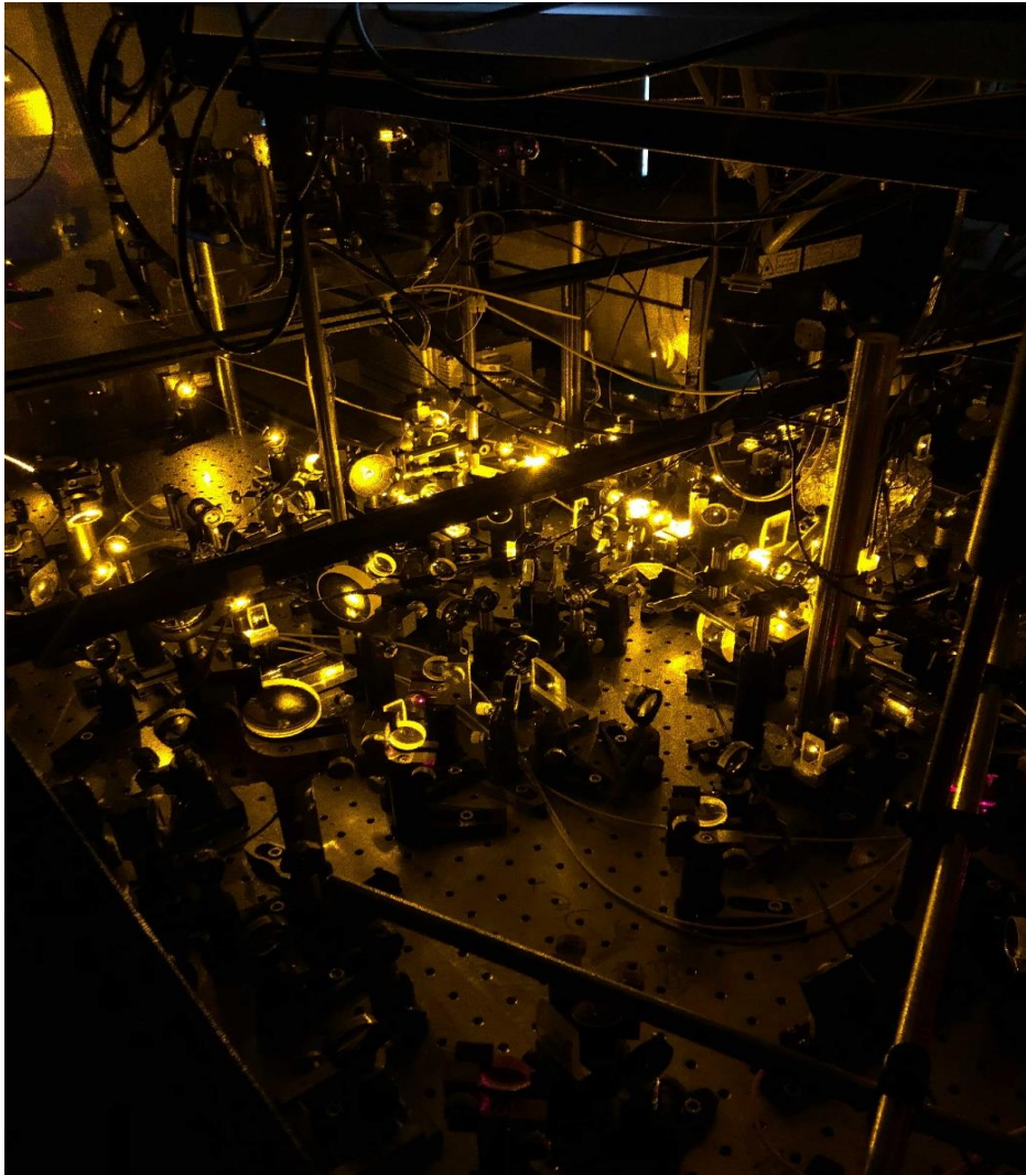
Optisches System zur Laserkühlung und Kontrolle von ultrakalten Natriumatomen im Labor am Kirchhoff-Institut für Physik Heidelberg © KIP Heidelberg
